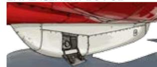
Le pod fumigène est placé sous le point central de l'Alphajet. Avant le vol, le mécanicien ouvre le robinet de la bouteille d'azote à la pointe du pod et contrôle la pression.
